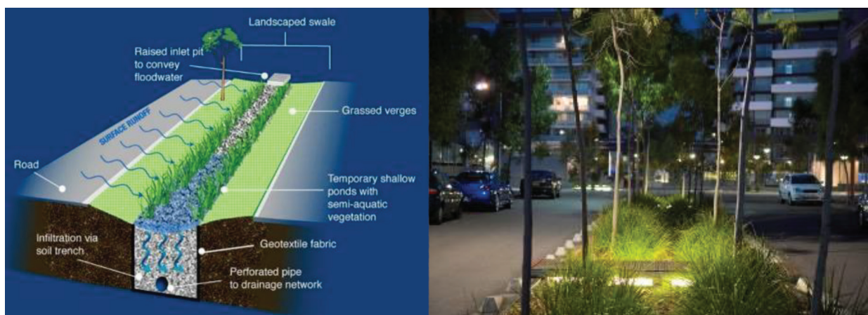
איור 38: ימין, מערכת ביופילטר סכמתית בקונפיגורציה של אי תנועה, שמאל, מערכת ביופילטר בוויקטוריה פארק, סידני, אוסטרליה / צילום: ירון זינגר
