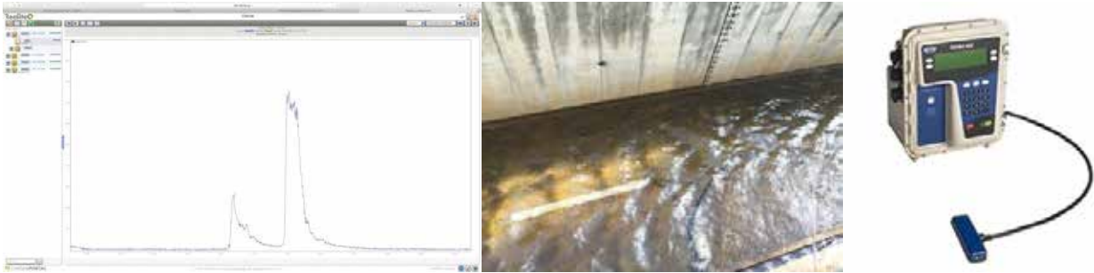
איור 9: מימין, מד הספיקה עם יחידת הסנסור. במרכז, התקנת ציוד הניטור/דיגום בתחתית התעלה. משמאל, דוגמא הידרוגרף של אירוע נגר בתחנה G 23.2.16 כפי שנצפה באתר האינטרנט / צילומים: יח"צ ועדי האפט
