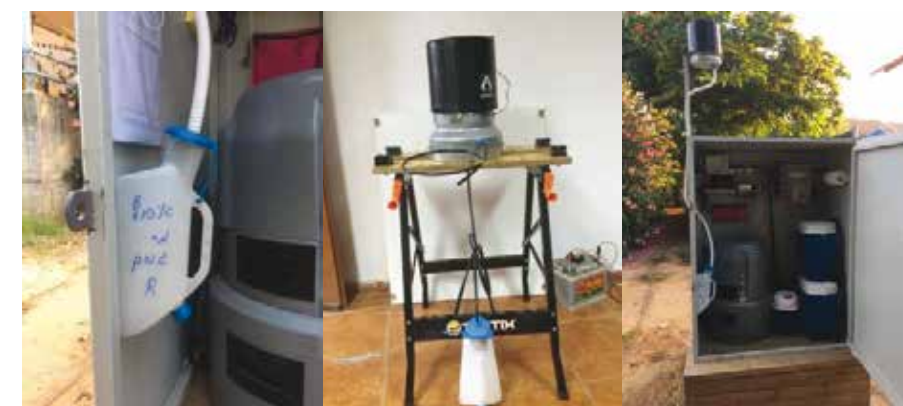
איור 13: משמאל, מיכל איסוף מי הגשם, במרכז, מתקן יעודי לאיסוף מי הגשם, מימין, ארון הדיגום עם מד הגשם המוגבה וצינור מי הגשם היוצא ממנו אל מיכל האיסוף הממוקם בתוך הארון / צילומים: עדי האפט
