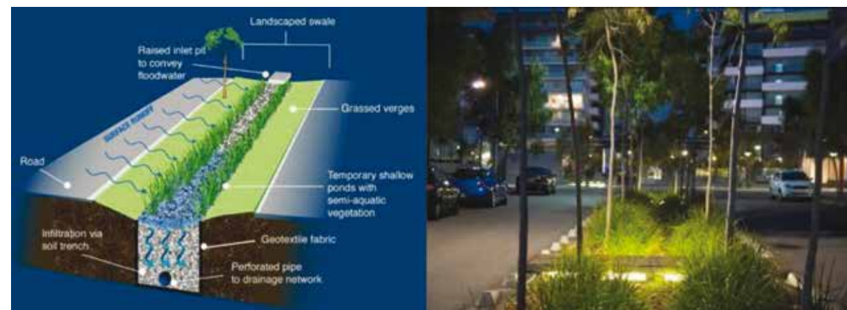
איור 38: ימין, מערכת ביופילטר סכמתית בקונפיוגרציה של אי תנועה, שמאל, מערכת ביופילטר בוויקטוריה פארק, סידני, אוסטרליה / צילום: ירון זינגר
